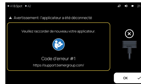
Affichage en cas de mise en garde (p. ex. applicateur non connecté à la console)
